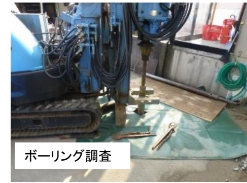
ボーリング調査とSWS試験の組み合わせ SWS試験の機動性を活かし、地層の分布(液状化層準)を把握する
