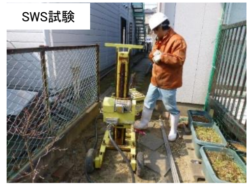
ボーリング調査とSWS試験の組み合わせ SWS試験の機動性を活かし、地層の分布(液状化層準)を把握する
