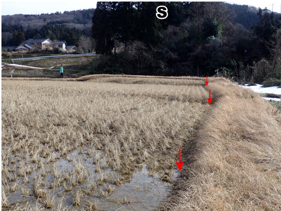
図7 水田や畦道に生じた3条の並走する南側上がりの段差（地点2）。段差の位置を赤矢印で示す。南に向かって撮影。（若山町中）
