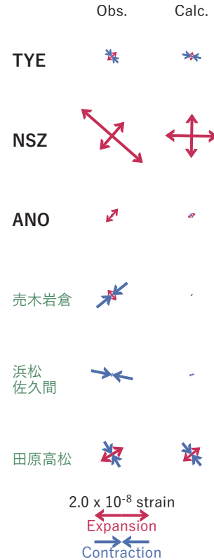
図6 2023/04/05-07の歪・傾斜変化 (図2[D]) を説明する断層モデル。
