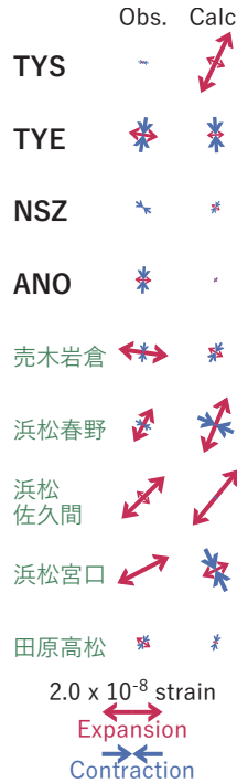
図3 2022/01/15-19の歪・傾斜変化（図2[A]）を説明する断層モデル。
