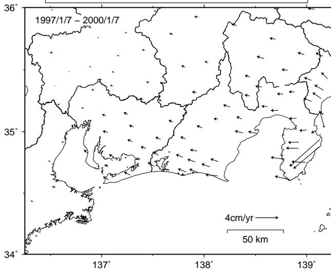
スロースリップ終息後の水平地殻変動速度
