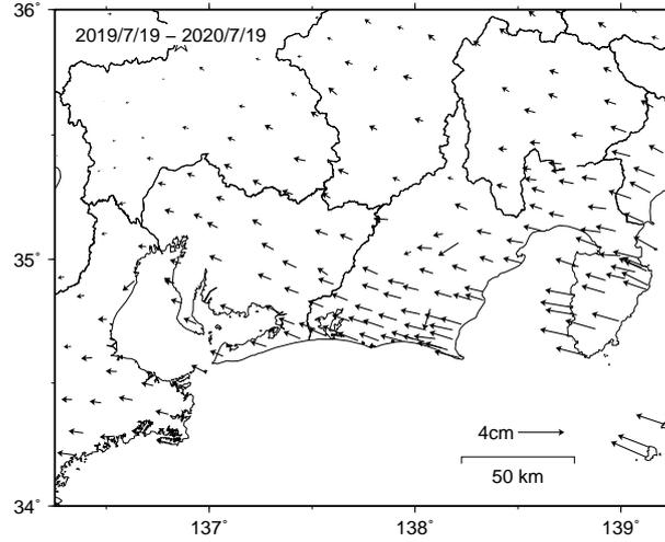
スロースリップ発生前の水平地殻変動速度
