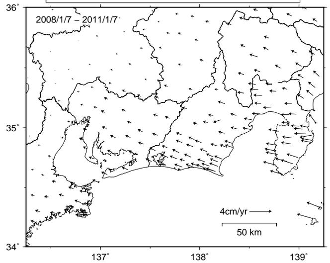
スロースリップ進行期の水平地殻変動速度
