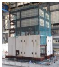
実験に用いた5層鉄骨試験体
