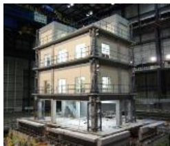
実験に用いた4層RC試験体
