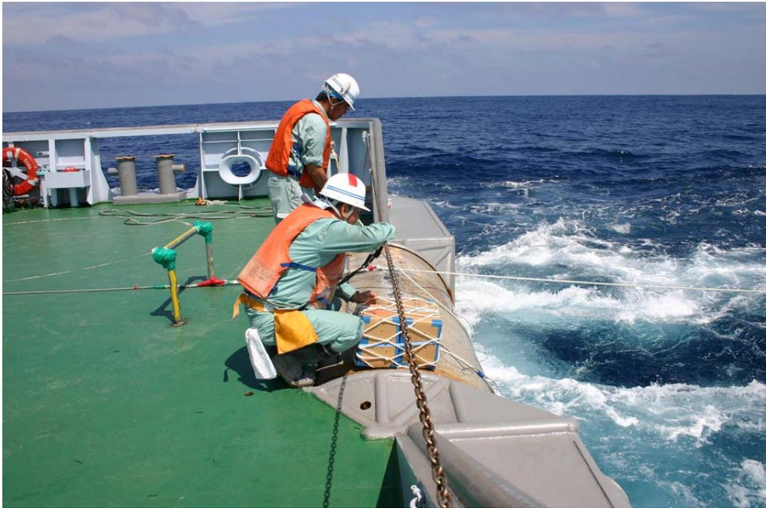
写真 2. 4. 1. a-1 爆薬（40kg）投入風景
