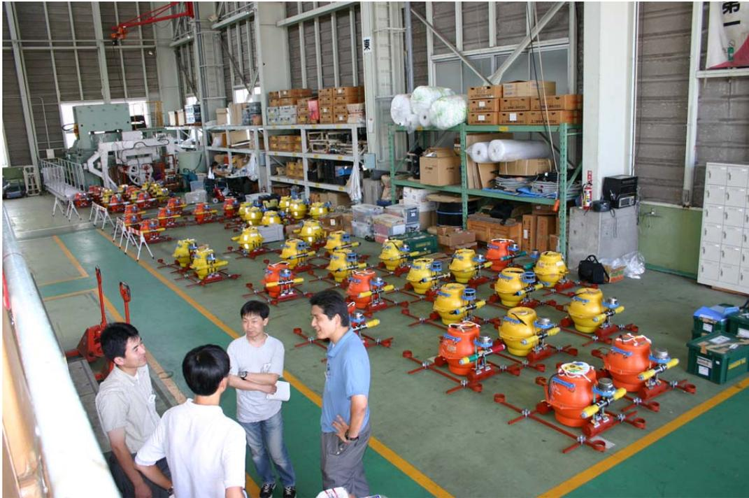
写真 2. 4. 1-1 海洋研究開発機構内で準備中の海底地震計
