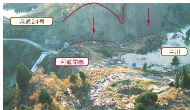
平成16年(2004年)新潟県中越地震 長岡市(旧山古志村)寺野地区 芋川右岸側河道閉塞状況 (国土交通省北陸地方整備局湯沢砂防事務所提供)
