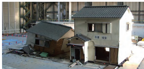
耐震補強の有無による木造家屋の震動破壊実験の様子
