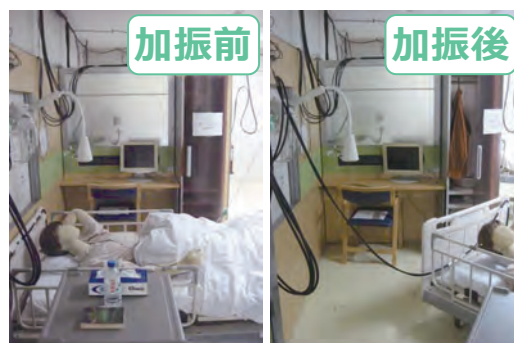
免震構造の病室内の様子（カスターフリーのベッドが大きく移動）
