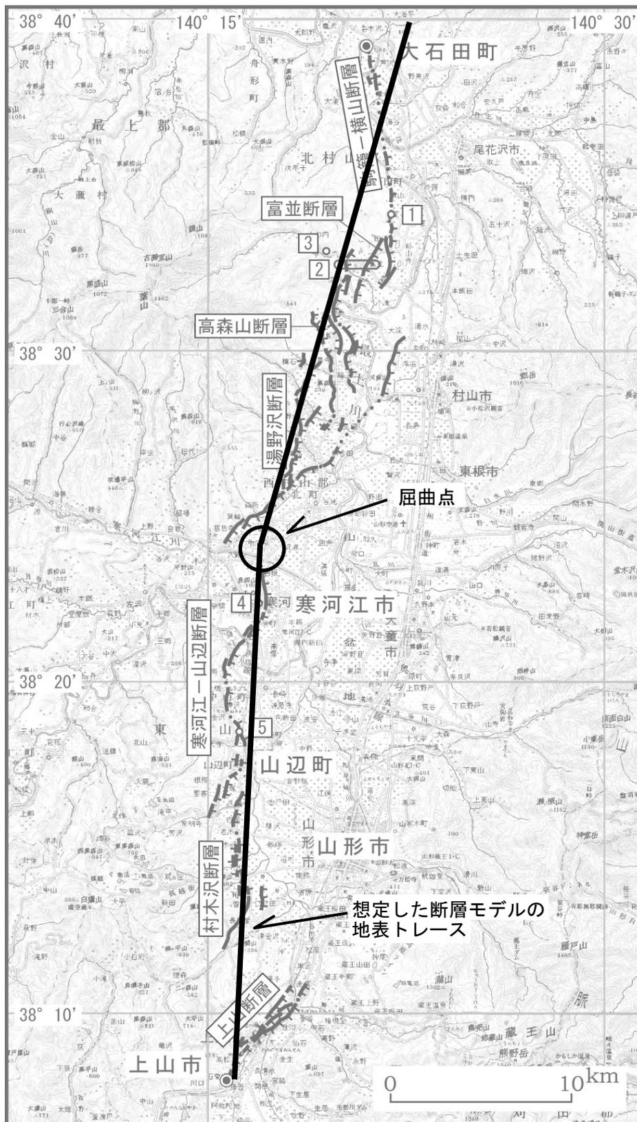
図1 山形盆地断層帯の活断層位置図と想定した断層モデルの位置
