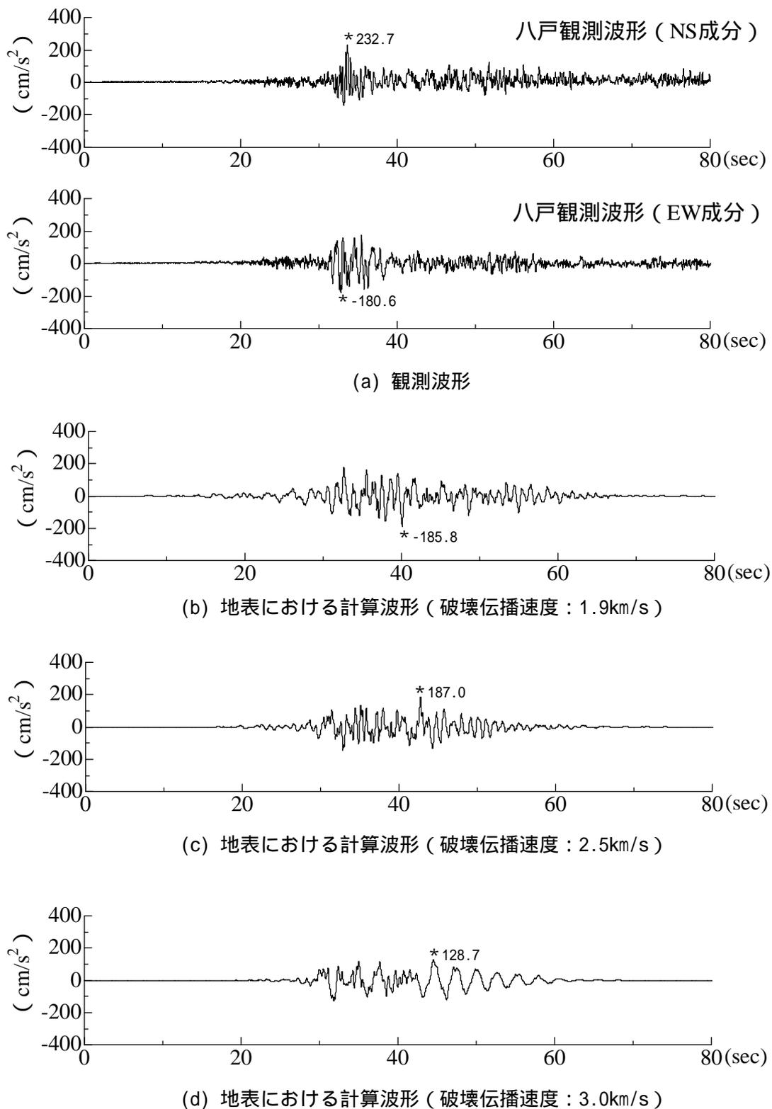
図 1 5 破壊伝播速度を変えた場合の「詳細法」による地表における計算波形と観測波形の比較
