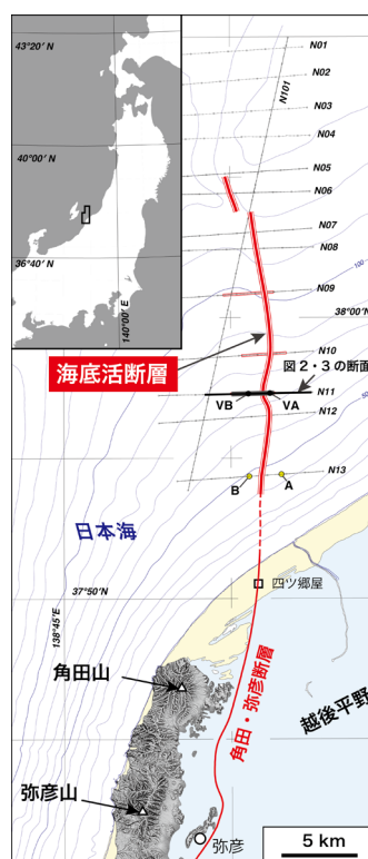
図 1：調査海域の位置図。 長岡平野西縁断層帯を構成する角田・弥彦断層の海域延長部に分布する海底活断層の正確な位置・形状と過去の地震活動を調査した。
