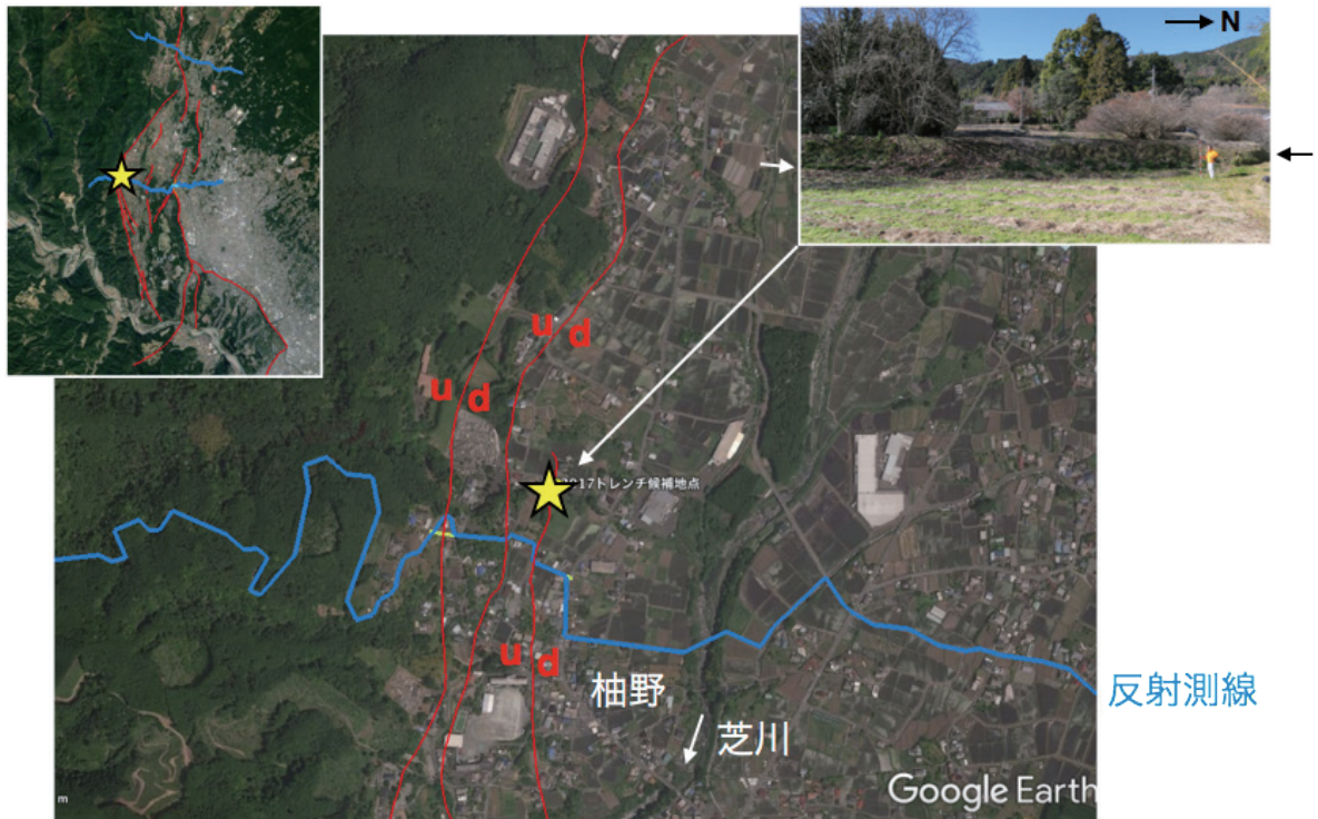
図2 芝川断層の概略位置図。星印は上袖野トレンチ掘削地点 u:隆起側、d:低下側 右上の写真はトレンチ掘削地点付近で完新世後期に形成された扇状地性段丘面を横断する低崖地形
