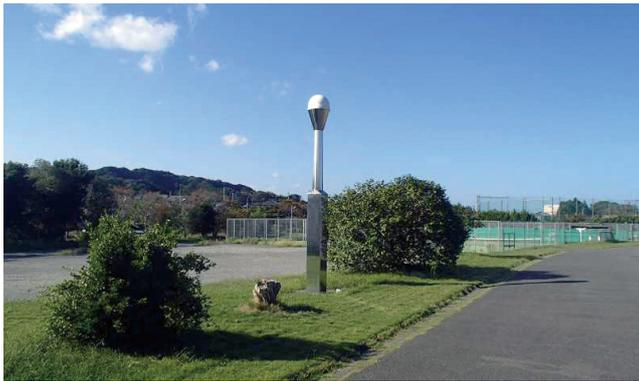
図3 今年6月のスロースリップに伴う地殻変動を捉えた電子基準点「千葉大原」の外観(電子基準点は主に学校や公園に設置されています)
