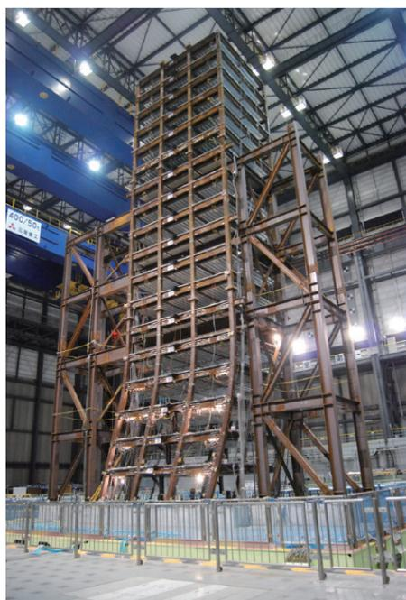
写真1 最終崩壊形
