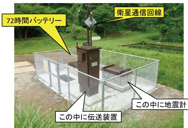
図2 地震観測点の機能強化
