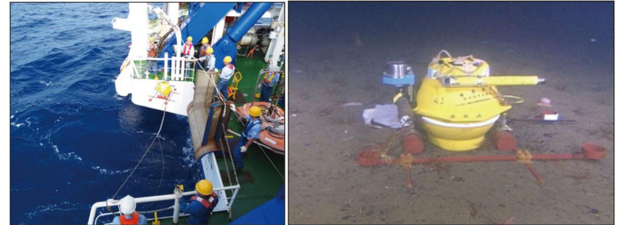
図2 自己浮上式海底地震計(OBS)の投入と、海底に設置されたOBS(提供: 海洋研究開発機構)
