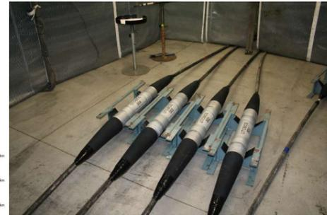
図2 日本海(栗島近海)に設置したインライン型海底地震計
