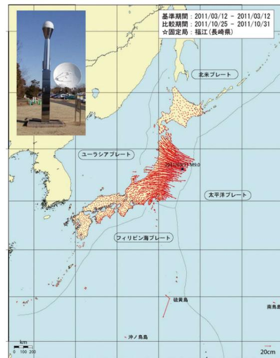
図1 電子基準点と変動ベクトル図
