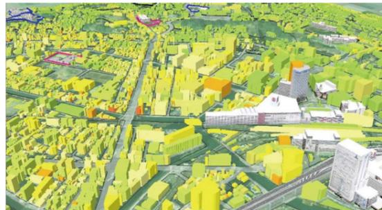
図 3次元地震危険度マップ（想定地震で予想される建物被害の程度をデジタルシティ上に示したもの）
