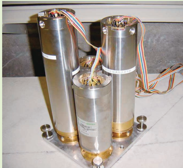
写真1 試験観測中の新しい広帯域地震計（左）と試験施設内の様子（右）
