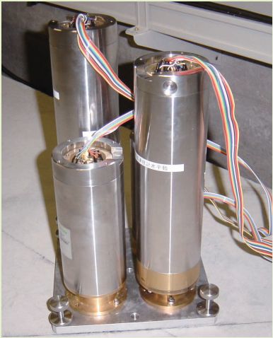
試験観測中の新しい広帯域地震計 （独立行政法人防災科学技術研究所 提供）
