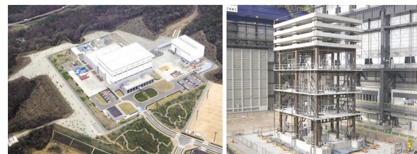
図3 実大三次元震動破壊実験施設(E-ディフェンス)と高層建物実大架構実験試験体
