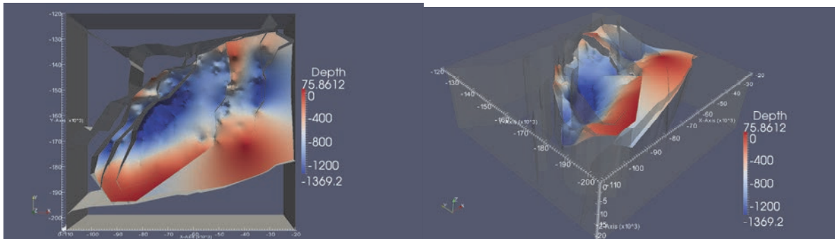
図 64 福田火山灰層に対する鍵層面補間結果 (上盤側と下盤側で独立に境界面を生成)
