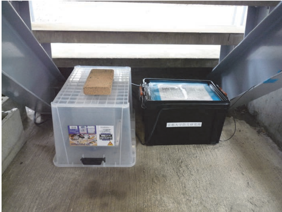
写真2 UEMC06 観測点における連続微動観測装置の設置状況
