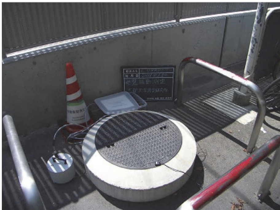
写真 1 泉大津市役所 (OSKP06) での単点微動観測実施状況。白い円筒状のものが微動観測に用いた地震計 LE-3D/20s、中央のハンドホール内に震度計センサーがある。
