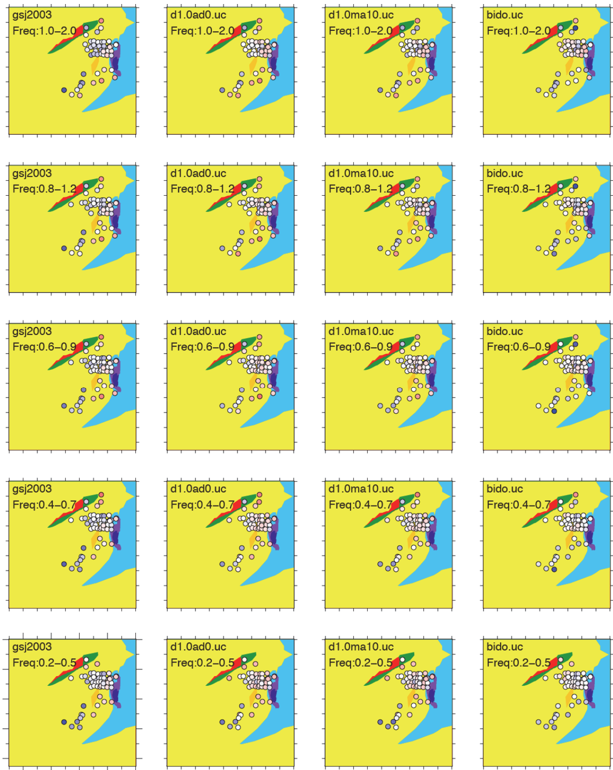
図 79 周波数帯域毎の観測位相速度と速度構造モデルの理論位相速度との比較（左から，産総研モデル，本業務深度補正値なし初期モデル，本業務深度補正あり初期モデル，微動アレイに基づく修正モデル）（赤：理論値が観測値よりも大きい，青：理論値が観測値よりも小さい）
