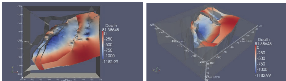
図 66 Ma-1 に対する鍵層面補間結果 (上盤側と下盤側で独立に面を生成)
