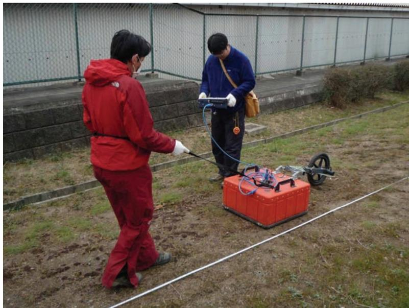
図 17 地中レーダー探査プロファイル測定法でのデータ取得の風景
