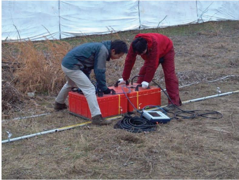
図 18 地中レーダー探査ワイドアングル測定法でのデータ取得の風景
