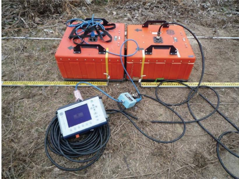
図 16 地中レーダー探査機器
