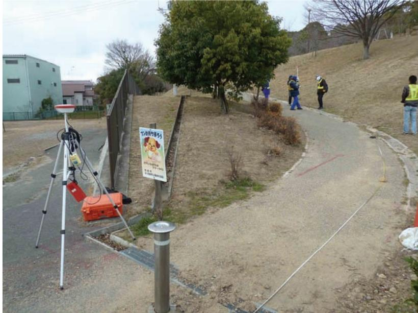
写真3 Real-Time Kinematic GPSによる測量風景。図の左側が基地局、図の右奥で立っているポールが移動局である。
