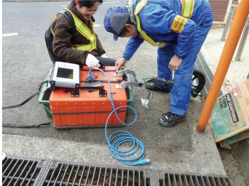
写真1 地中レーダー探査機器。中央のオレンジ色の箱が送受信アンテナ（GSSI 社製 Model-5106）。アンテナ上の液晶画面の付いた白色の箱が制御・記録装置（GSSI 社製 SIR-3000）。
