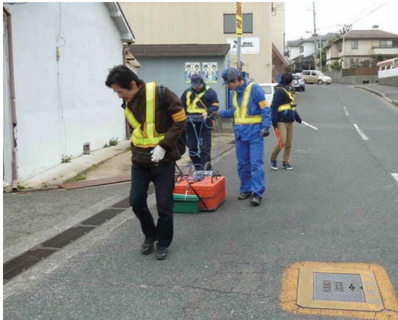
写真2 地中レーダー探査データ取得の作業風景。アンテナ前方の人間（茶色の服）が送受信アンテナを牽引して移動させ、アンテナ後方の人間（紺色の服）が送受信制御・データ収録を行う。また、図のように探査中は交通警戒を行う（アンテナ斜め後方の赤白の棒を持った人間）。
