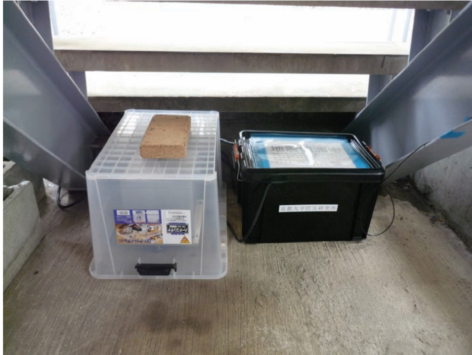
写真3 連続微動観測装置の設置状況 (UEMC06 地点)
