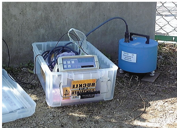
写真4 観測に使用した機材。左側の青い円筒形が地震計、ポリボックスの中の装置がロガー。
