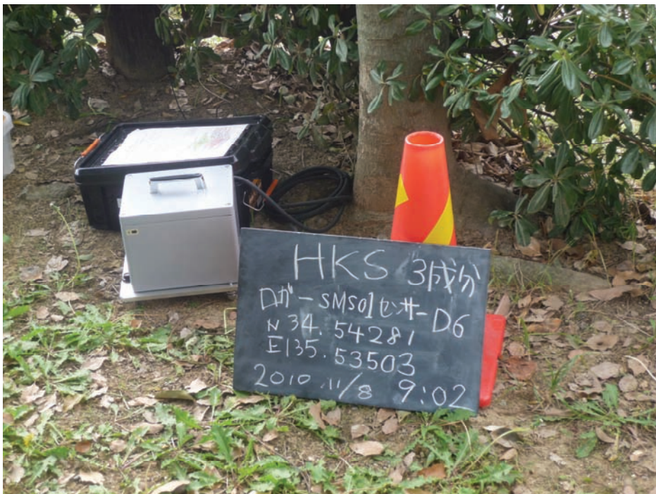
写真2 堺市東区日置荘（HKS）における単点微動観測実施状況
