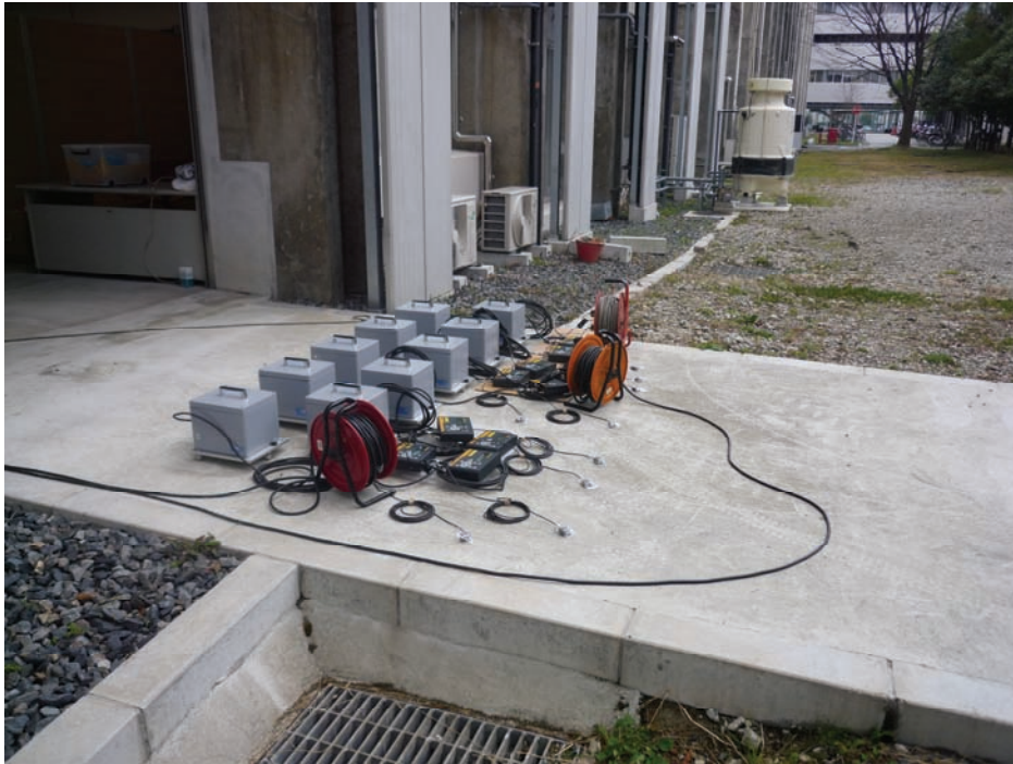
写真1 京都大学防災研究所構内におけるハドルテストの様子
