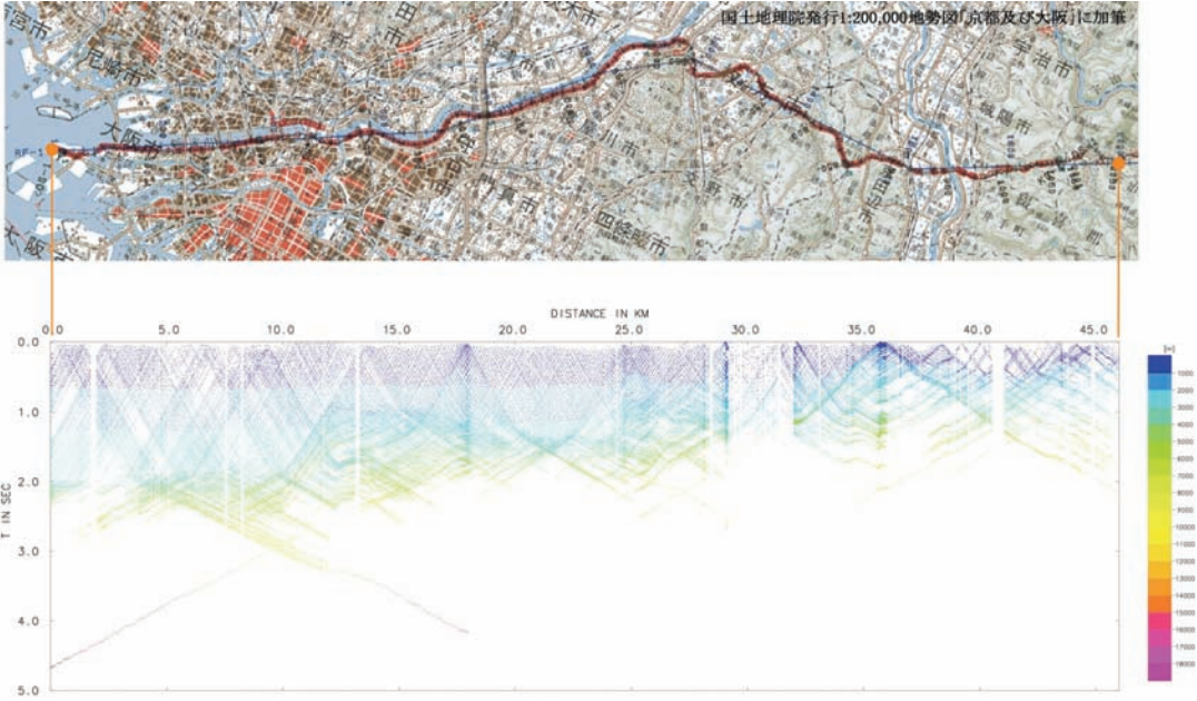
図11 屈折初動読取結果（大阪－鈴鹿測線）
