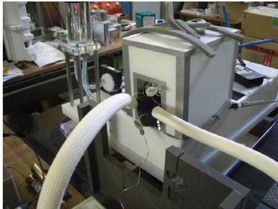
写真2 加圧装置とセンサーを接続する高圧配管部分
