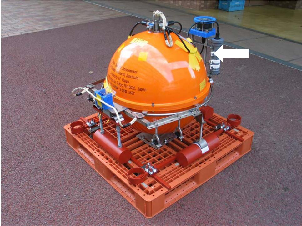
写真3 広帯域海底地震計に装着した高精度水圧計(白矢印により示す)
