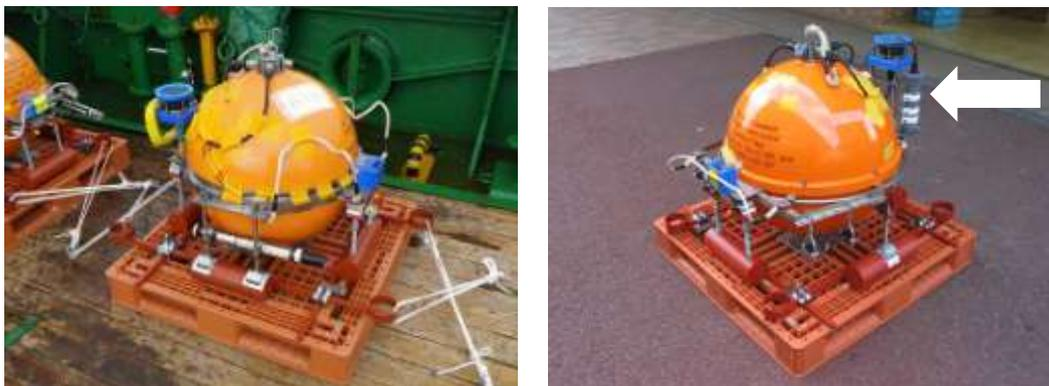
観測に使用した広帯域海底地震計。矢印は、高精度水圧計センサーの位置
