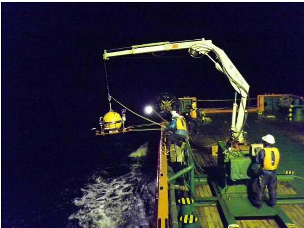
写真2 広帯域型海底地震計の投入風景
