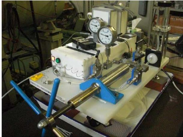
写真1 水圧センサー室内実験に用いる加圧装置
