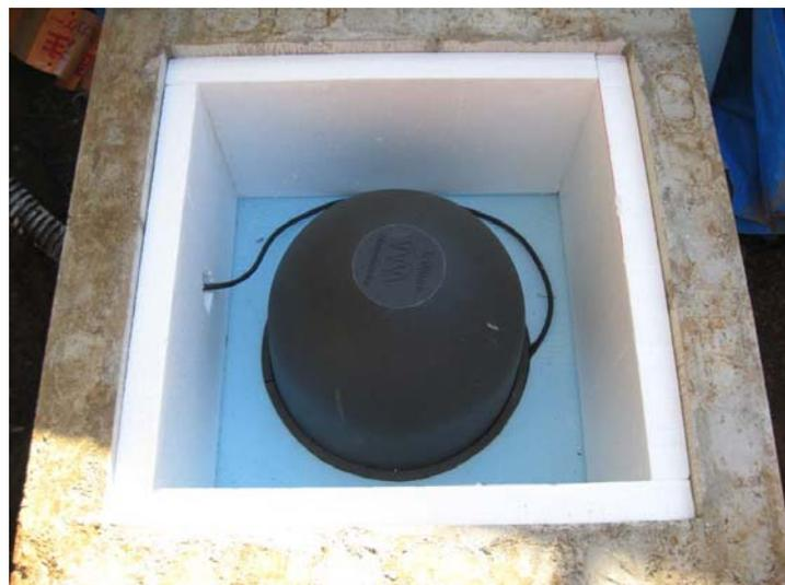
写真 1 地震計室の内部の様子と設置された広帯域地震計
