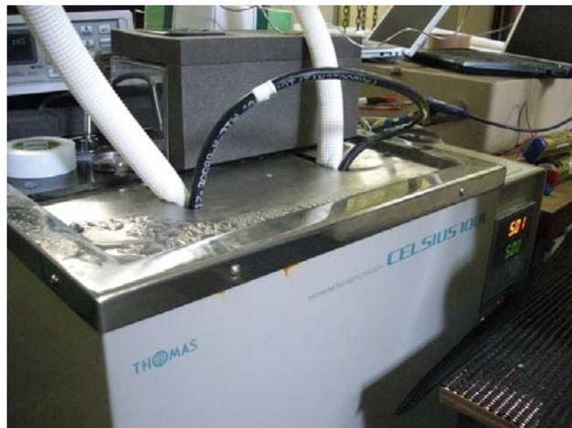
写真3 水圧センサーが入っている恒温水槽
