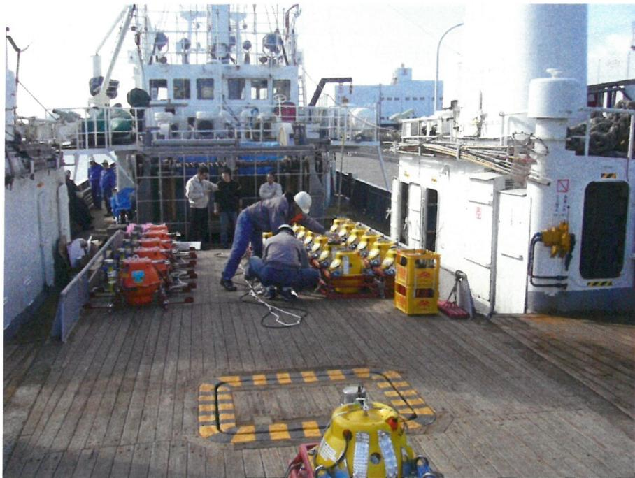
図 3 海底地震計および水圧計の準備作業風景。黄色いケースに納められているのが海底地震計、橙色のケースに収められているのが水圧計。
