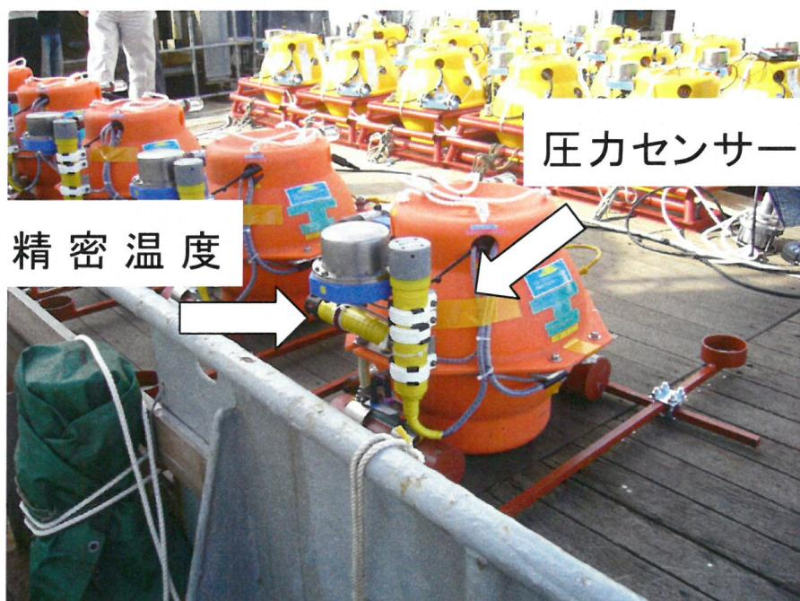
図 4 海底水圧計。橙色のケース内に電源電池とデータ収録装置を納めた 17 インチ耐圧ガラス球が入っている。圧力センサーと精密温度計は、耐圧容器の外側に取り付けられている。
