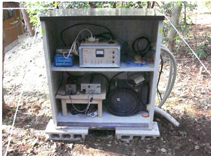
写真7 観測用筐体の内部に配置された地震計コントロールユニット（上段中央）、高精度 A/D 装置（上段左）等。
