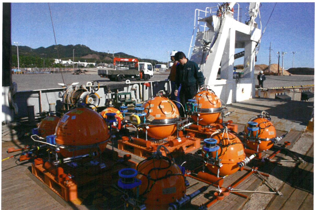
図4：最終調整が完了し、設置する船舶の甲板上に並べられた広帯域海底地震計と長期観測型海底地震計（平成20年12月）
