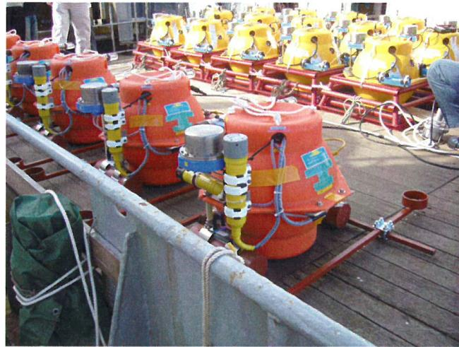
図2：観測準備が完了した海底地震計（奥側の黄色のケースのもの）と海底水圧計（手前側の橙色のケースのもの）。
