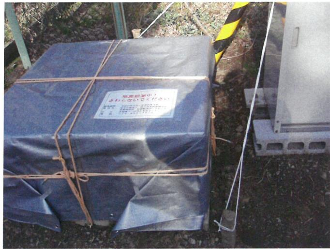
写真6 防水・断熱シート。最終的な地震計室の外観。
