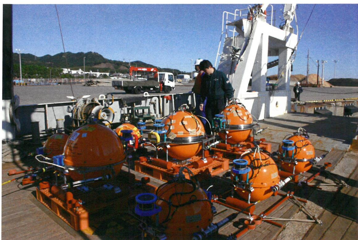
写真1 最終調整が完了し、設置する船舶の甲板上の海底地震計（平成20年12月）
