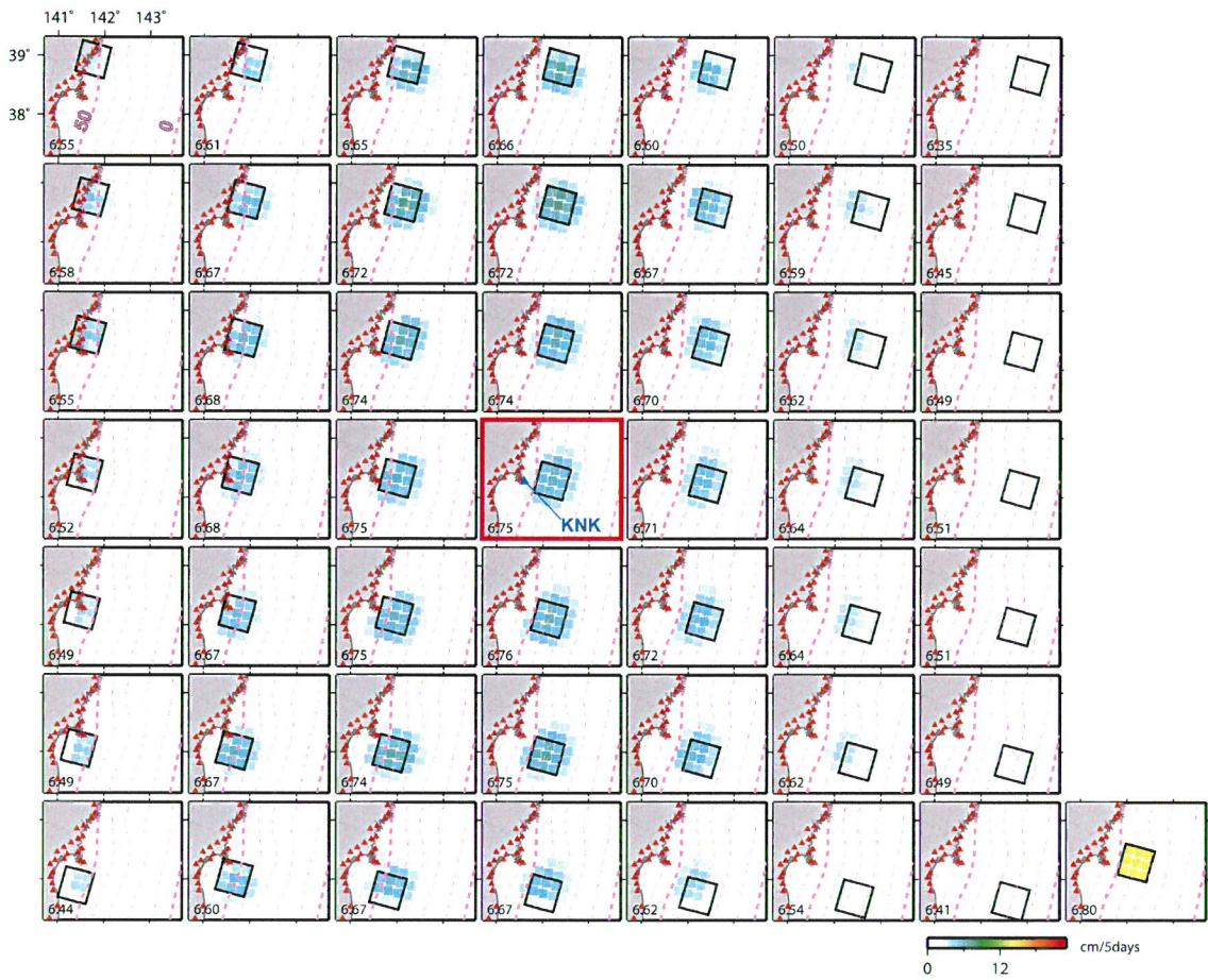
図 7 陸上の GPS 観測網のデータだけを用いて推定したプレート境界すべり分布。赤三角印で GPS 観測点の位置を示す。右下にあるような大きさとすべり量のすべり域を、解析領域内で移動させて、そのときに得られる疑似地殻変動データの逆解析により推定されたすべり分布を示す。各パネルの矩形が、すべりイベントの位置。赤線で枠をつけたケースの KNK 観測点で得られる地殻変動時系列を図 8 に示す。
