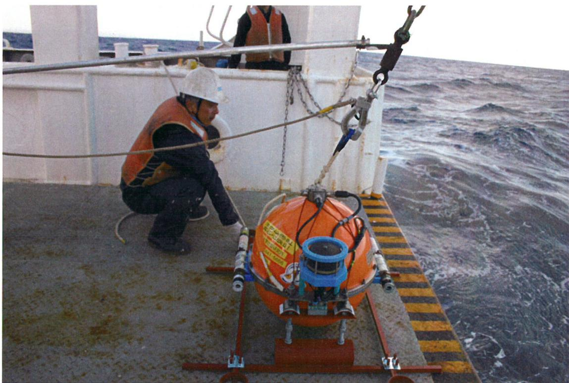
写真2 投入直前の長期観測型海底地震計
