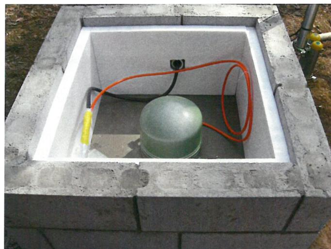
写真3 STS-2 地震計の設置と断熱材の壁面設置。
