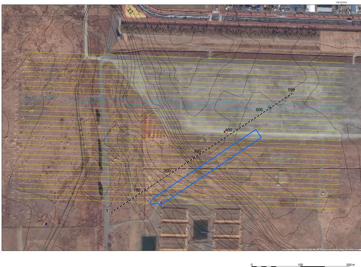
図 10 極浅層反射法地震探査・榎測線の位置図（重合測線）。青い枠線は榎トレンチの位置を、黄色線は三次元反射法地震探査測線を示す。背景の黒線は航測図化によって復元した人工改変前の地形を示す。
