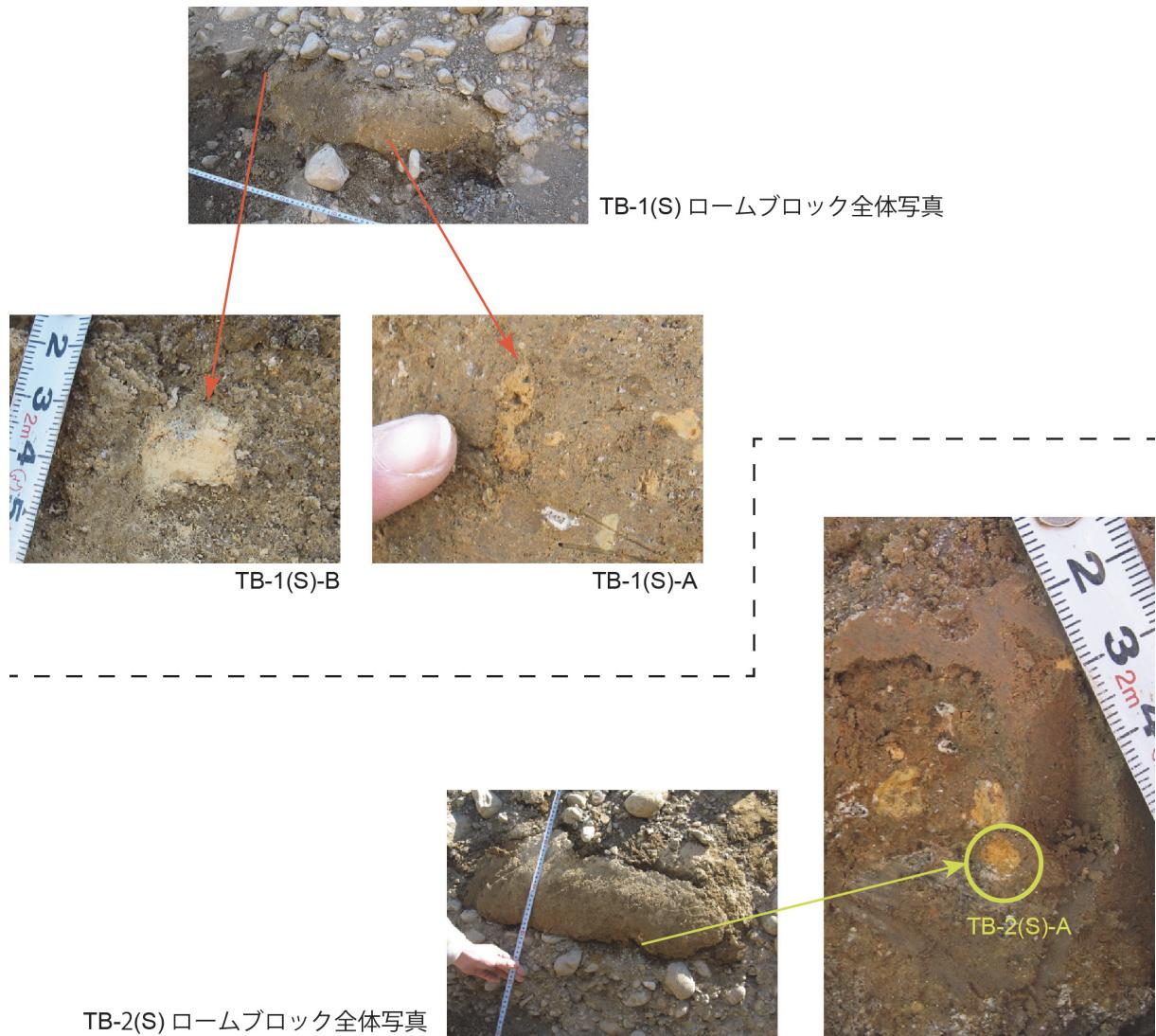
図 10 檻トレンチ壁面で採取した火山灰土ブロックとその中に含まれる軽石粒子
