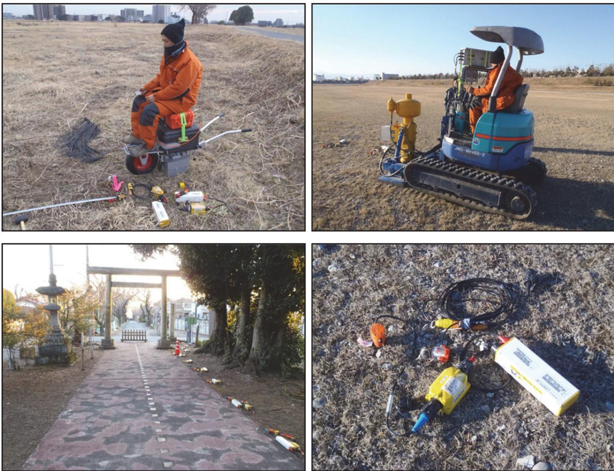
図 11 極浅層反射法地震探査の作業の写真。(左上) 檻トレーニチ測線における小型 S 波バイブレーター (Geomatrix 社製 ELVIS) による発震。(右上) 檻トレーニチ測線における小型 P 波インパクターによる発震。(左下) 阿豆佐味天神社測線の展開風景。(右下) 使用した独立型収録機器 (Geospace 社製 seismic recorder GSR-1)。
