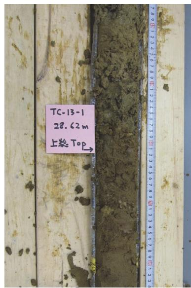
図 5 TC-13-1 コア中で確認された礫層の基底（深度 28.62 m、標高 80.88 m）
