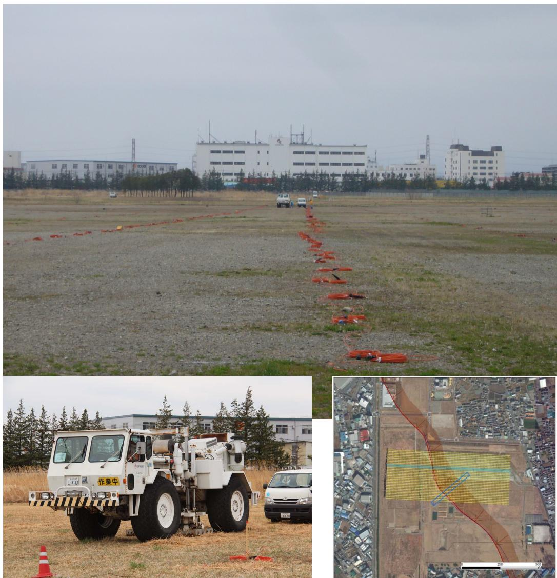
三次元反射法地震探査・探査風景（上）、S波二次元探査に使用したバイブロサイズ（左下）、測線図（右下）（赤：立川断層、赤色帯：撓曲部、黄丸：上下動受振器、水色丸：三成分受振器、青枠：榎トレンチの位置）
