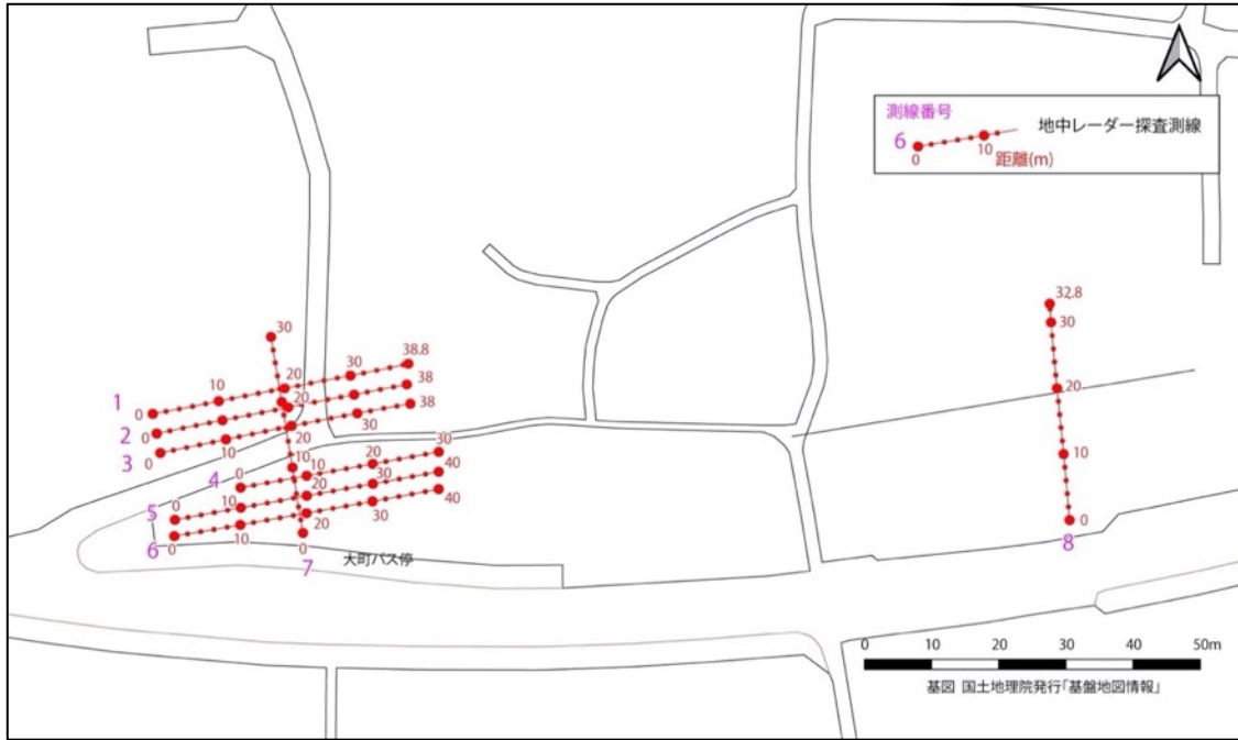
図 122 地中レーダ探査測線の配置状況（四国中央市豊岡町大町地区）。
