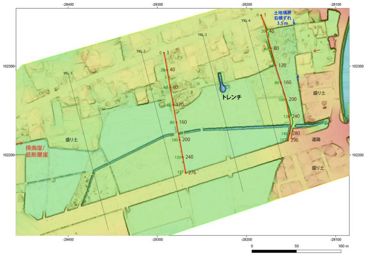
図 143 西条市横黒地区の活断層・撓曲崖の分布。 基図はドローン LiDAR による 0.1mメッシュ DEM
