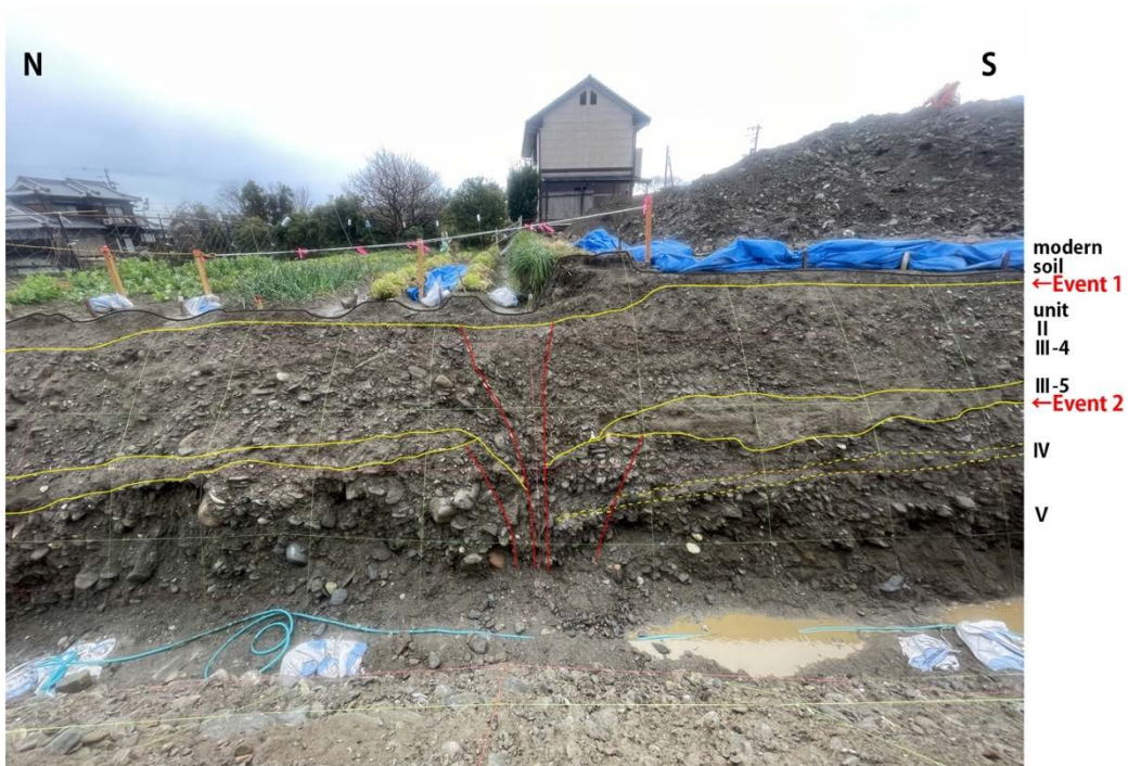
(上段) 1596年文禄の歴史地震と連動範囲との対応。(下段) 岡村断層・新居浜市大生院トレンチにおける東壁面の断層とイベント解釈。最近2回の古地震イベントが識別される。
