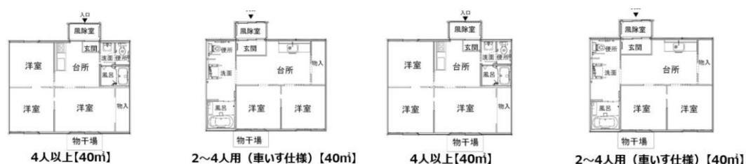
図 2－2－2－65 ふるさと回帰型仮設住宅の間取り。
