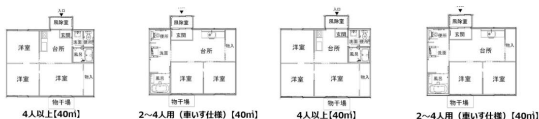
図 2－2－2－65 ふるさと回帰型仮設住宅の間取り。
