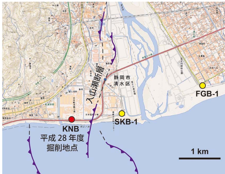
図3-7-⑦-1 富士川河口周辺におけるボーリング掘削地点の位置と活断層の分布。活断層の位置は尾崎ほか(2016)に基づく。基図は地理院地図(電子国土Web)を使用。
