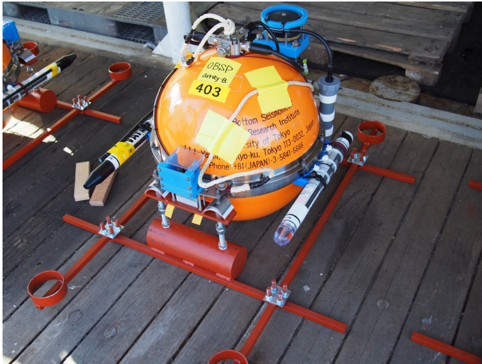
図 3-8-②-6 平成 28 年度に設置した圧力計付き長期観測型海底地震計
