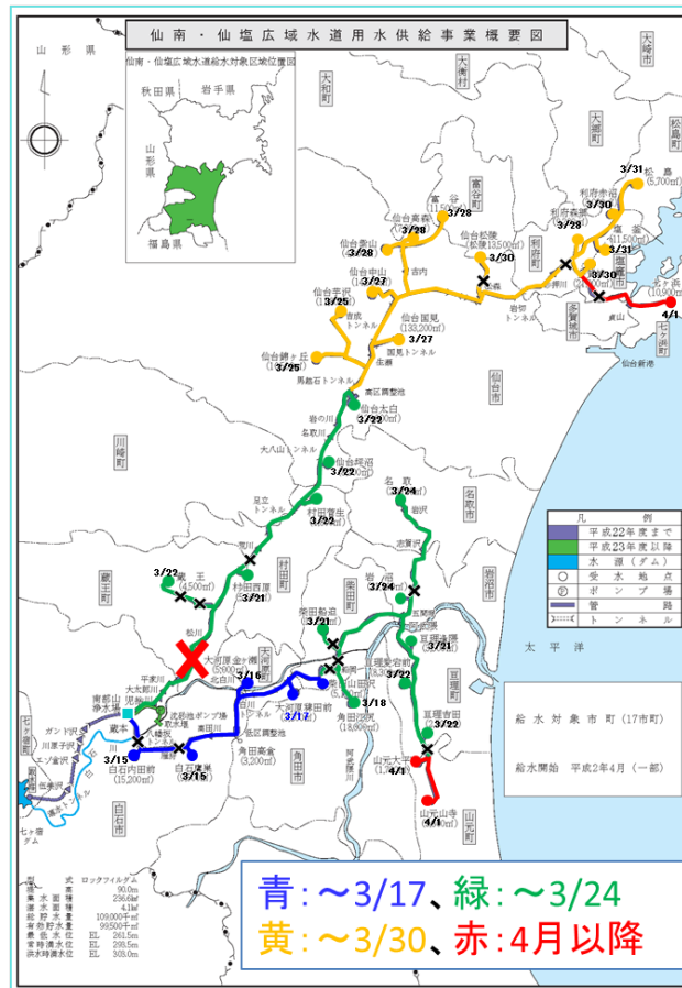
図3-1-⑤-7 宮城県広域水道用水供給ネットワークの復旧過程 (宮城県企業局, 2012に筆者加筆)
