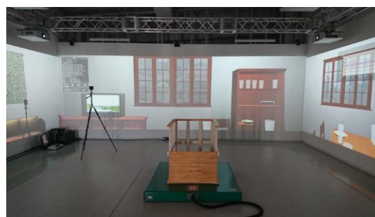
図 3-2-④-3 大振幅振動台「パレットぶるる」
