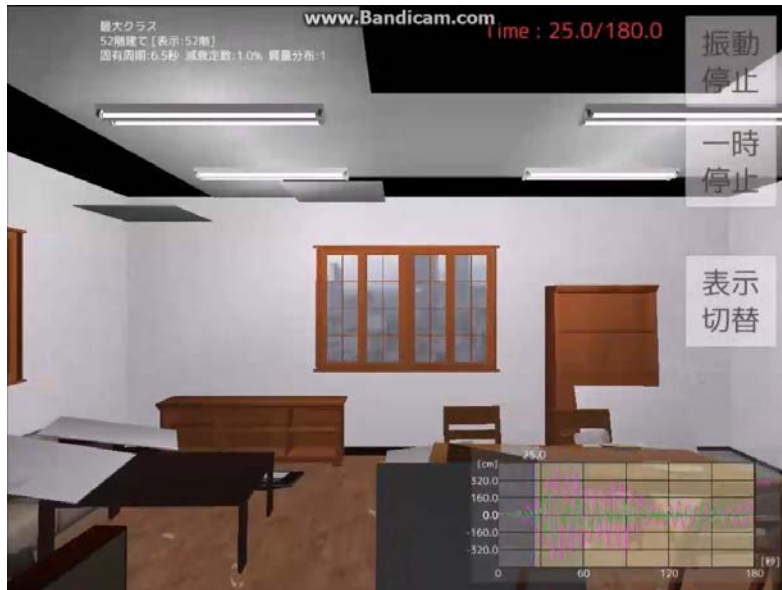
図 3-5-②-6 室内応答画面の拡張（天井パネル落下の様子）
