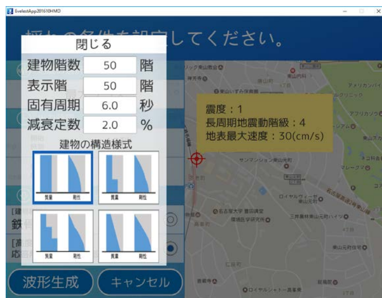
図3-5-②-5 超高層建物の高さ方向の質量分布および剛性分布の設定
