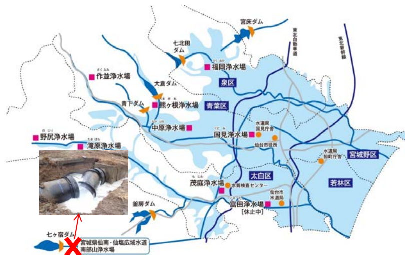
図3-1-⑤-1 仙台市給水区域（仙台市水道局，2012に筆者加筆 ×印が送水管単線ラインでの大口径鋼管被害が生じた箇所）
