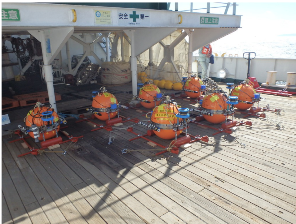
図 3-8-②-5 平成 28 年度に設置した海底地震計
