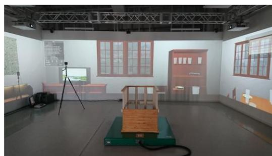
図 3-2-④-3 大振幅振動台「パレットぶるる」
