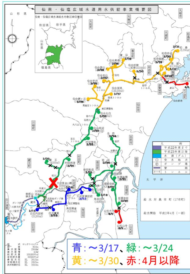
図3-1-⑤-7 宮城県広域水道用水供給ネットワークの復旧過程
