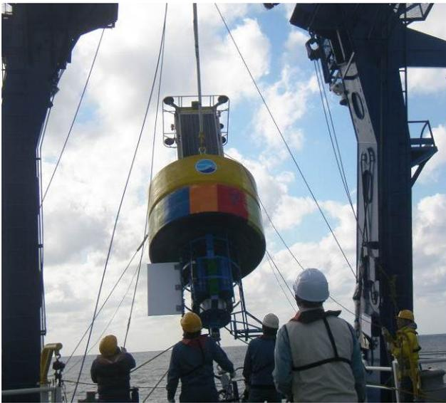
図14 リアルタイム広帯域水圧観測システムにおける観測データを陸上に中継するための海面ブイの投入作業
