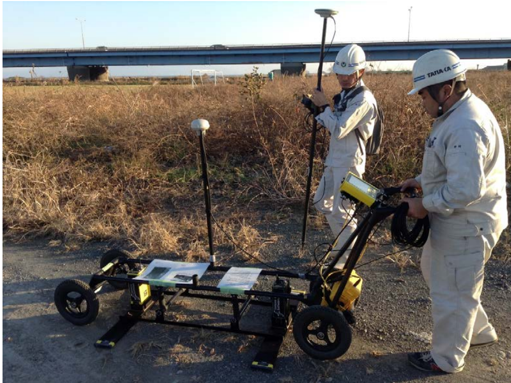
図 3 - 7 - ⑤ - 2 GPR 探査の様子 (2016 年 1 月 4 日撮影)
