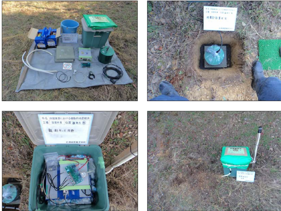
図 3-6-②-15 観測点④における稠密地震観測の様子。(左上) 設置に使用した観測機材。(右上) 穴を掘り、底に地震計を設置している様子。(左下) 観測ケース内の状態。(右下) 観測点④における観測風景。
