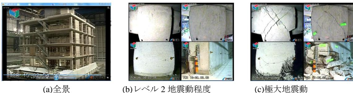
図 3-2-④-12 E-ディフェンス加振における現行設計骨組の損傷程度（実験後）
