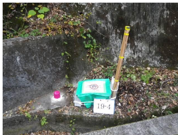
写真3-6-②-1 追加設置した臨時地震観測点の様子。赤い筒状の容器の中に地震計を設置し、収録装置ならびに乾電池を収納した観測箱は、緑色のビニルシートで保護した。GPSアンテナは右側の木柱に取り付けた。
