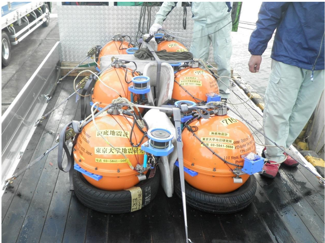
図 3 - 8 - ② - 5 回収した海底地震計の搬出
