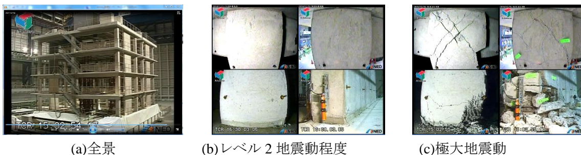
図 3-2-④-12 E-ディフェンス加振における現行設計骨組の損傷程度（実験後）
