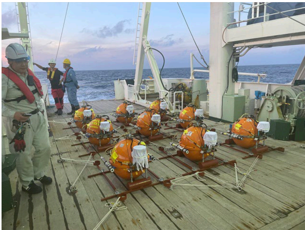
写真 2 - 2 - ③ - 2 観測船に搭載された海底地震計
