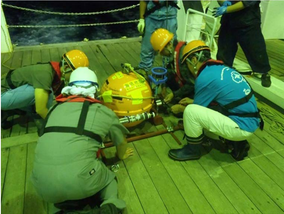
写真 2 - 2 - ③ - 3 今回新たに整備した小型広帯域海底地震計と海底地震計設置前準備作業
