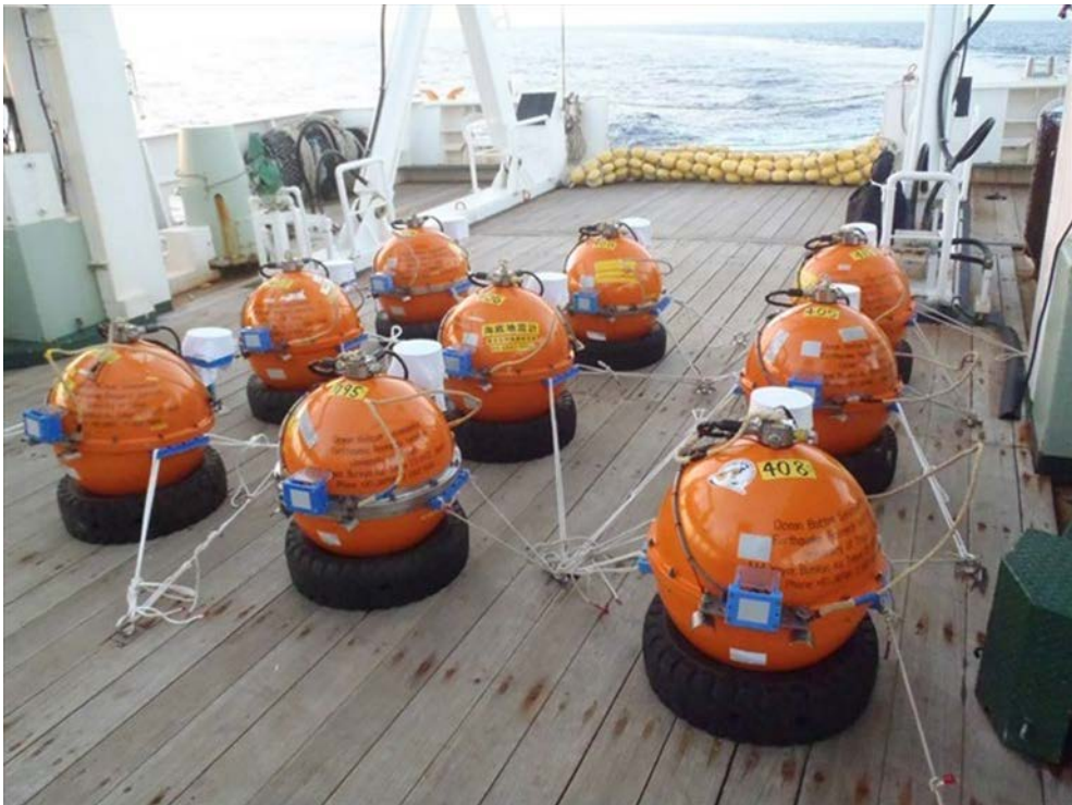
写真 2 - 2 - ③ - 6 回収された海底地震計
