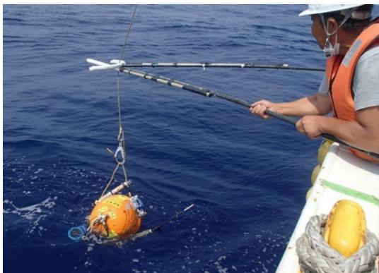
写真 2 - 2 - ③ - 5 海底地震計回収
