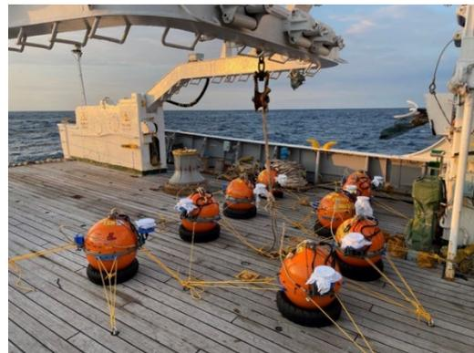
写真 2 - 2 - ③ - 6 回収された海底地震計
