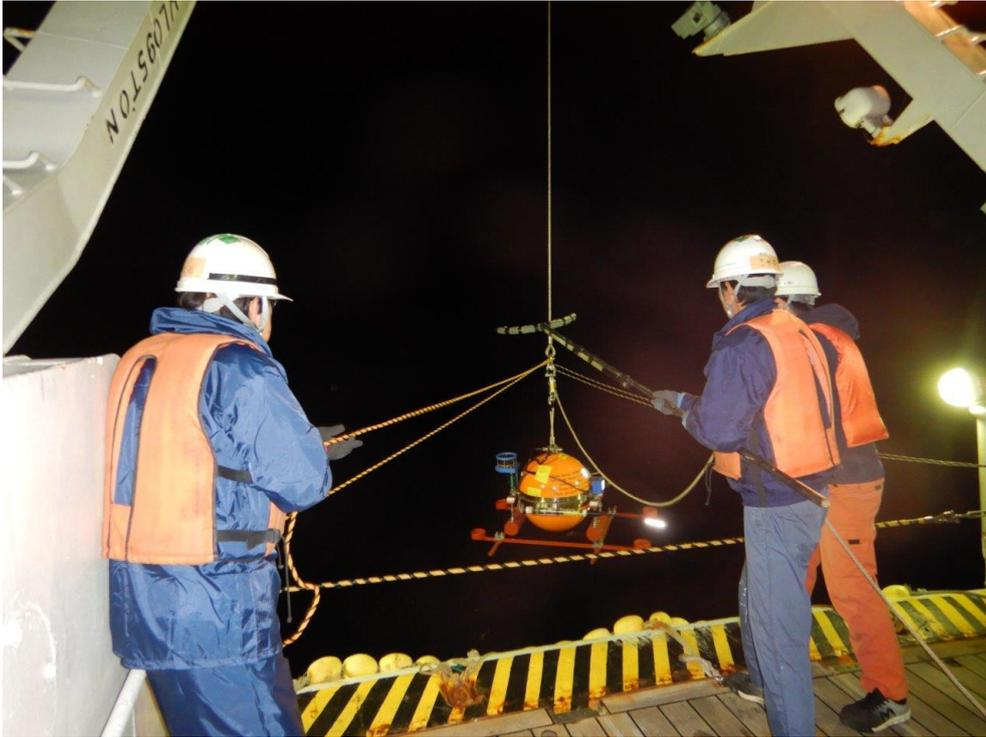
写真 2 - 2 - ③ - 5 海底地震計投入作業の様子。
