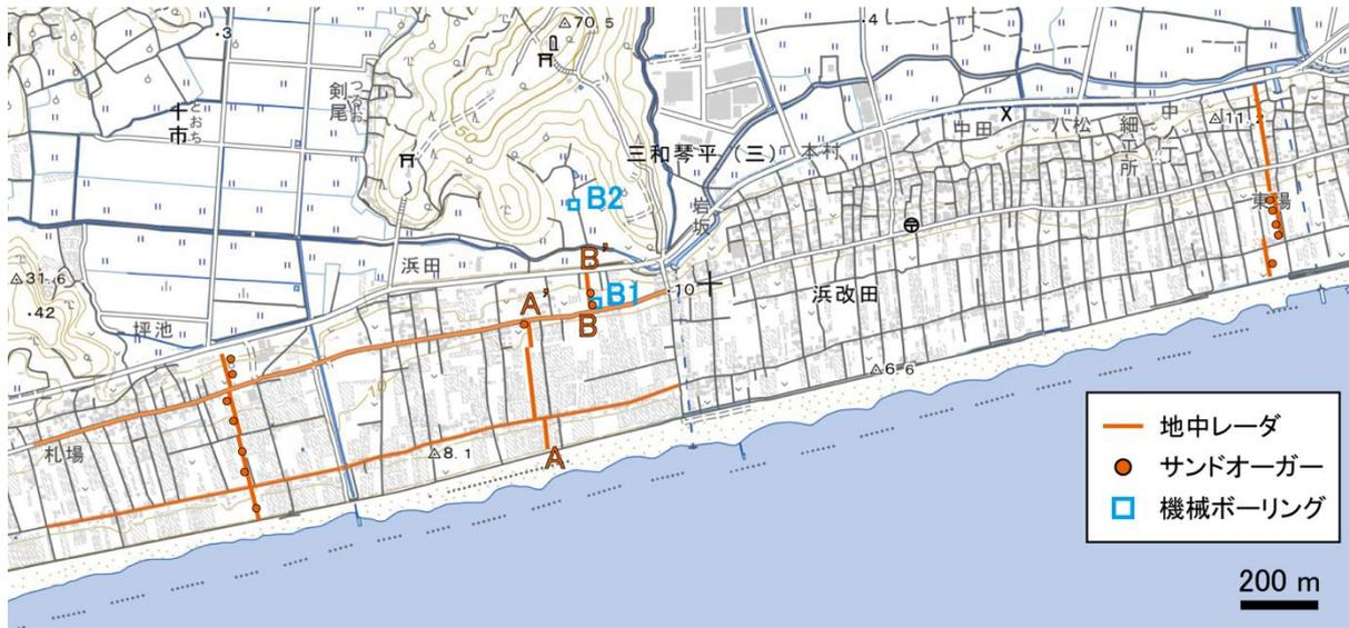
図 2-3-③-9 高知市南国市の調査地域。GPR 探査の測線と掘削地点を示す。基図には国土地理院の地理院地図を使用。
