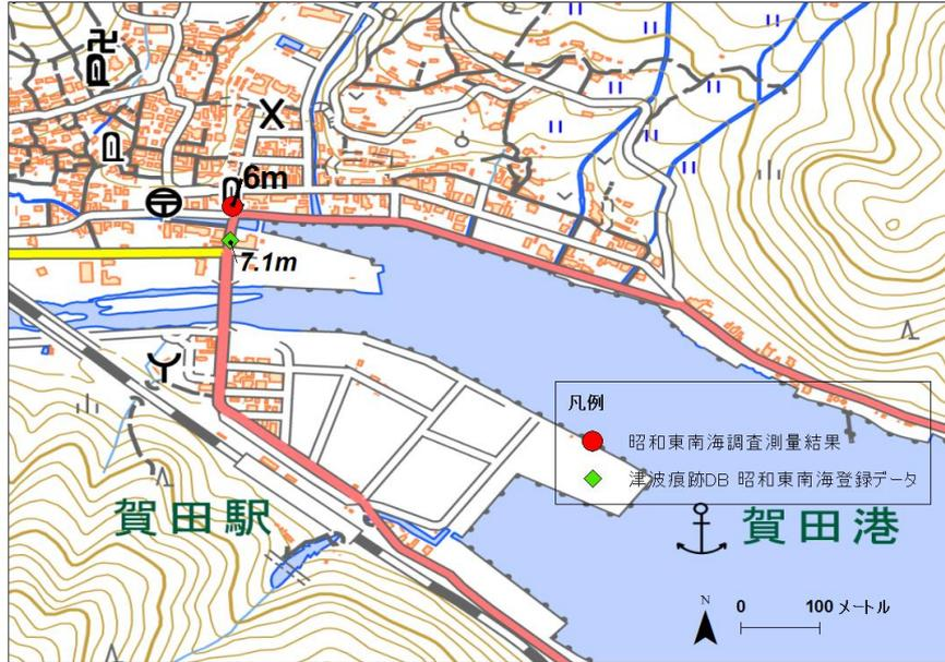
図 2-3-④-13 尾鷲市賀田の津波碑での津波浸水高測量結果。国土地理院の地理院地図を加工。
