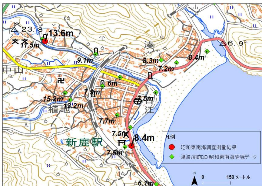
図 2 - 3 - ④ - 17 熊野市新鹿町の津波碑での津波遡上及び浸水高測量結果。国土地理院の地理院地図を加工。
