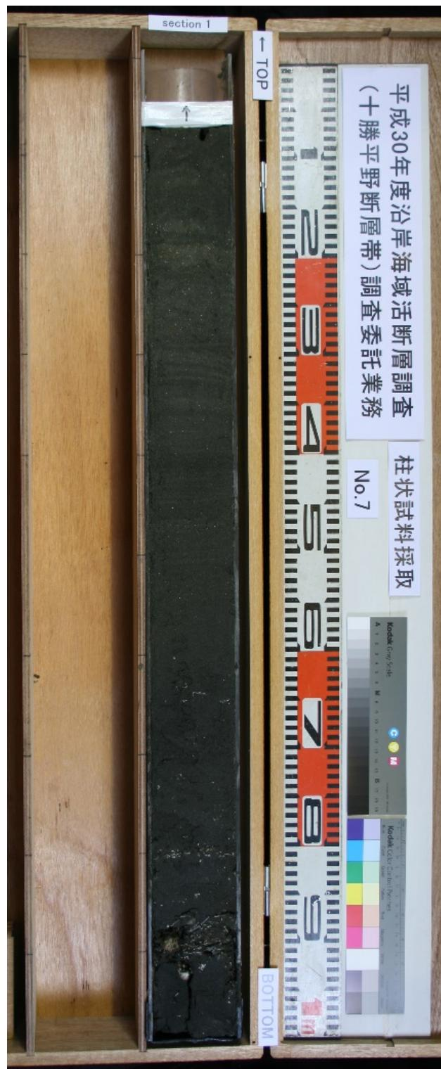
図 10-4 柱状採泥調査で得られたバイブロコアの写真 (TKC-7)。
