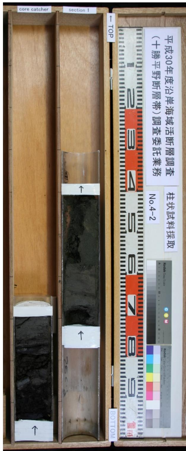
図 10-3 柱状採泥調査で得られたバイブロコアの写真 (TKC-4)。
