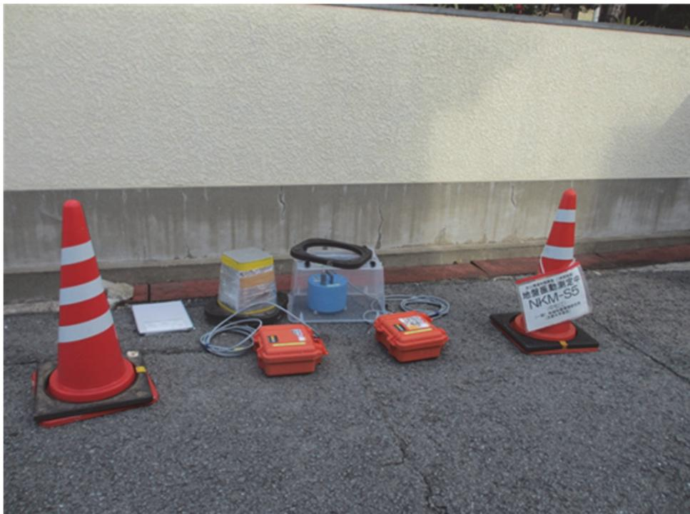
写真5 微動アレイ観測点の現場状況（中松江、S5 地点）。青色の筒状の筐体が地震計、その外側の半透明のケースは風除けのカバー、手前のオレンジ色の筐体がデータ記録器、地震計はシルバーの風除けカバー内にもあり、ここでは2台の地震計で観測。
