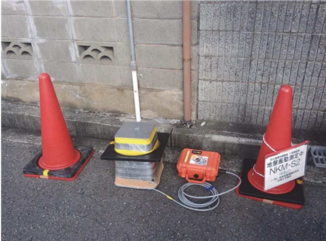
写真4 微動アレイ観測点の現場状況（中松江、S2 地点）。地震計はシルバーの風除けカバーの中、隣のオレンジ色の筐体がデータ記録器。
