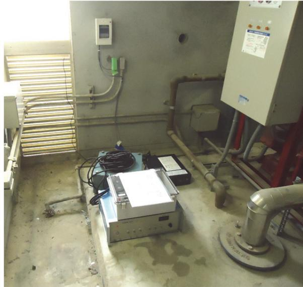
写真1 新規地震観測点の機器設置状況（左は野崎西小学校(nzk)の階段下の倉庫内、右は四箇郷小学校(skg)の階段下の非常用ポンプ室内)
