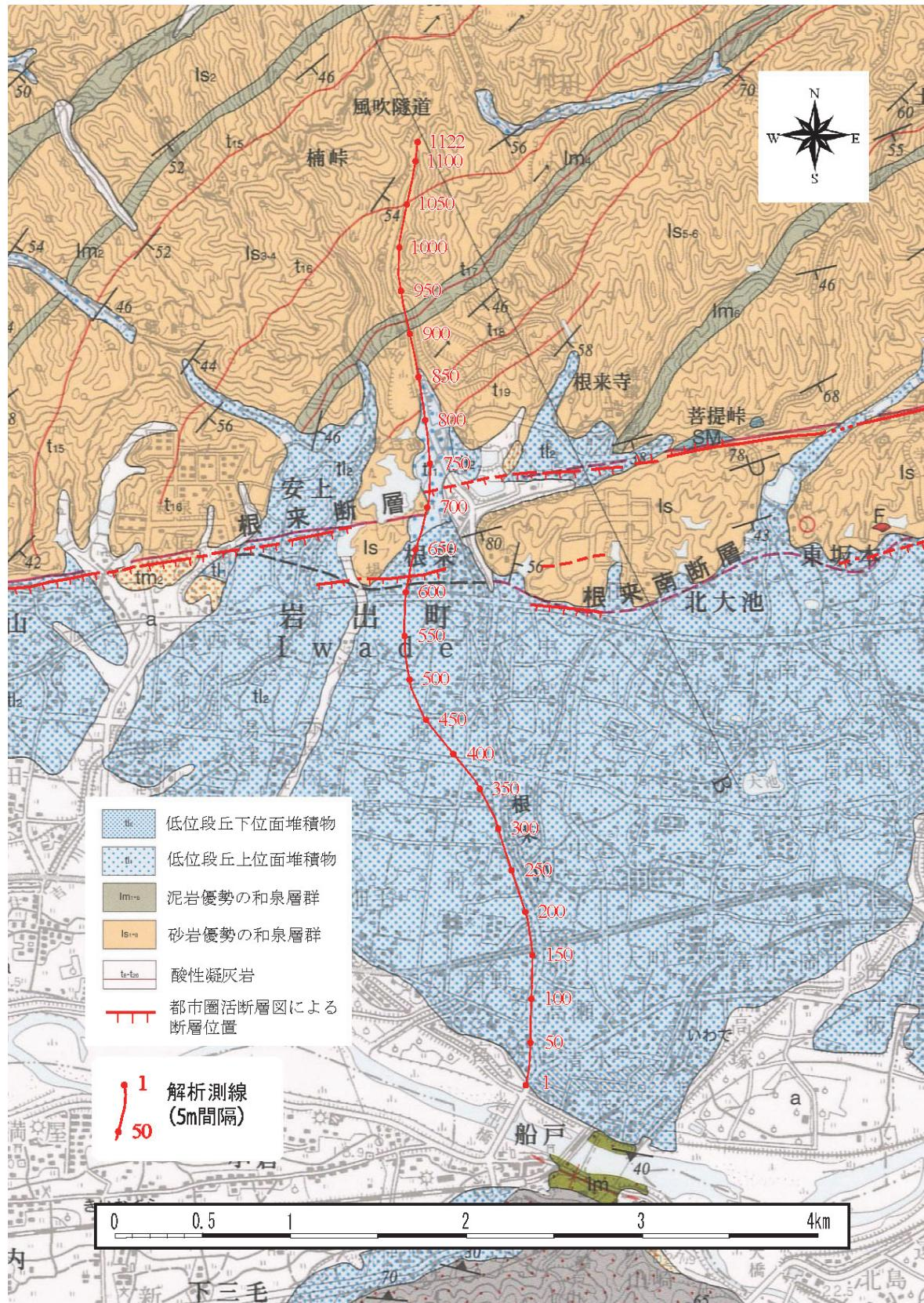
図 15(2) 岩出測線と周辺の地質状況および活断層位置図。地質図は牧原・他(2004)による。
