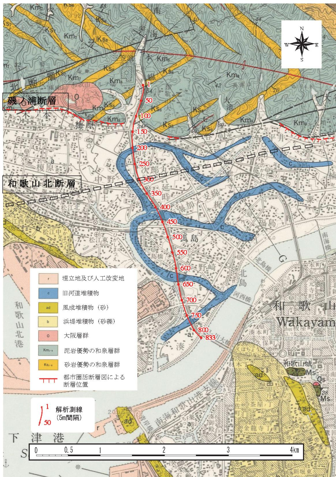
図 15(1) 和歌山北測線と周辺の地質状況および活断層位置図。地質図は宮田・他(1993)に一部加筆。和歌山北断層は伏在断層。
