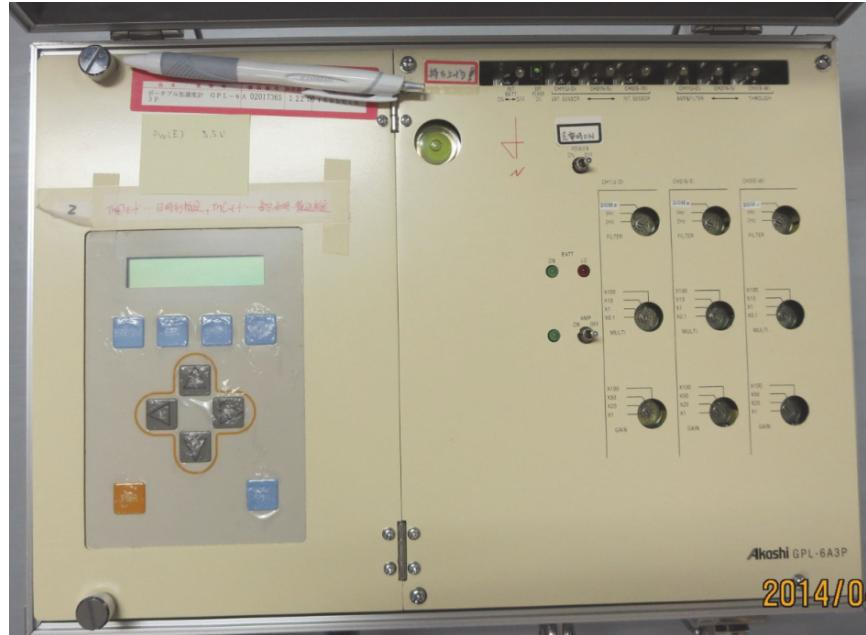
写真 3 広域単点微動観測に用いた観測機器（左側パネル部がデータ記録部、右側のスイッチ類がゲインやハイカットフィルターを設定する部分）
