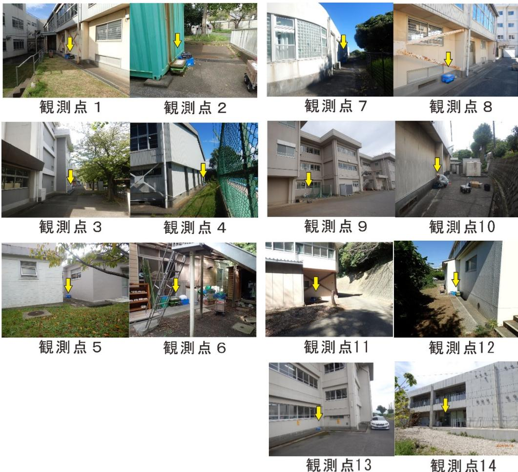
各臨時強震観測点での観測機器の設置状況の例
