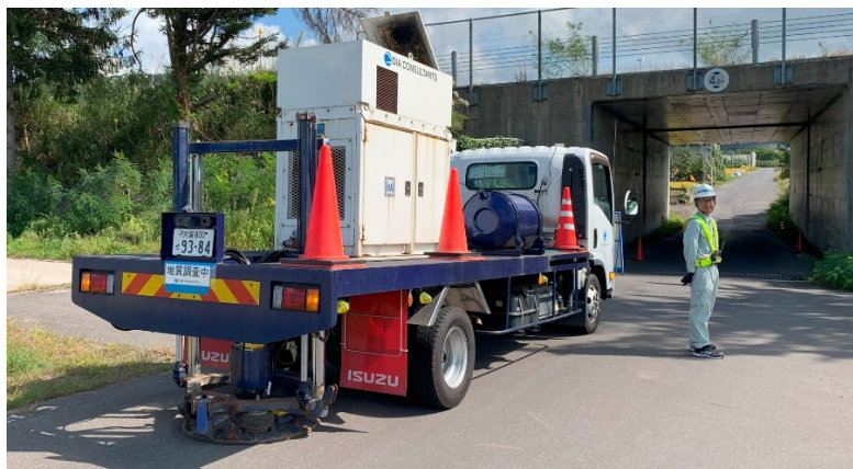
平川市新屋地区における反射法地震探査の様子
