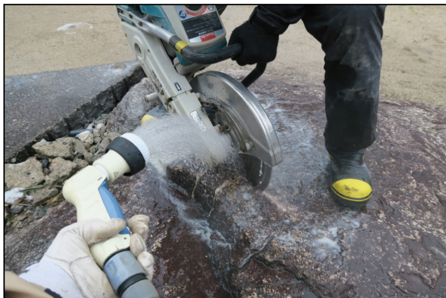
堆積物（巨礫）の試料採取状況
