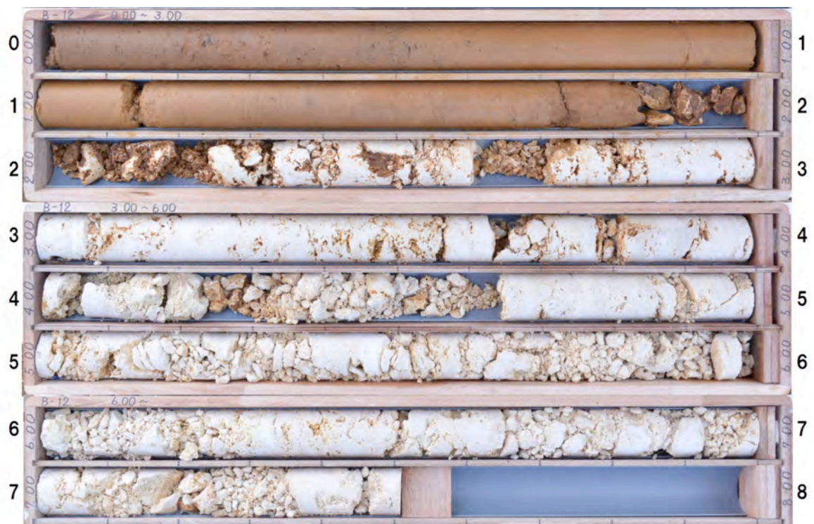
図 40 B-12 孔コア写真 数字は深度 (m)
