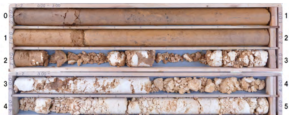
図 36 B-2 孔コア写真 数字は深度 (m)
