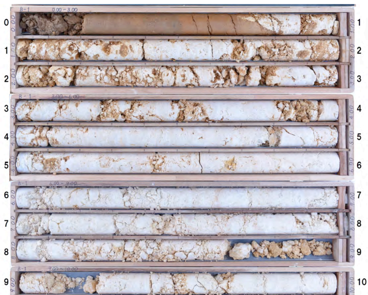
図 34 B-1 孔コア写真 数字は深度 (m)
