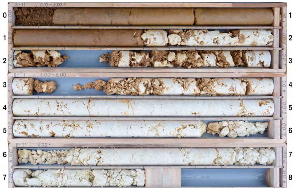
図 38 B-11 孔コア写真 数字は深度 (m)
